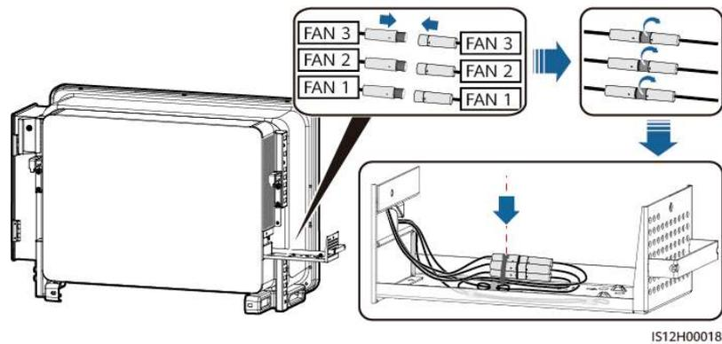
Étape 10 Poussez le plateau du ventilateur dans la fente et serrez la vis.
