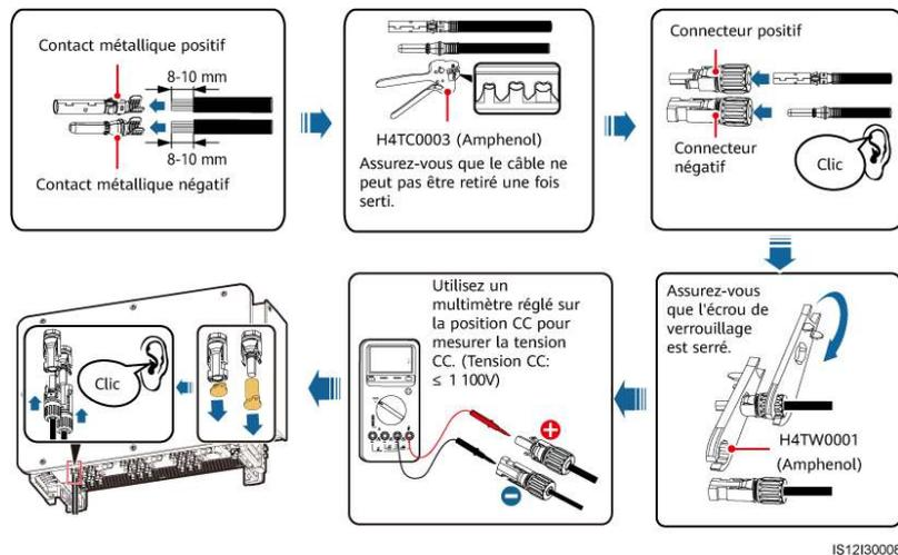
Figure 5-24 Connexion des connecteurs
