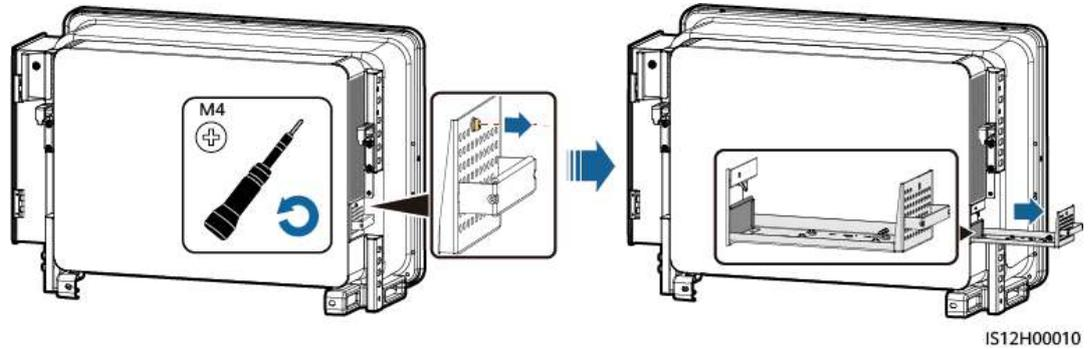
**Étape 2** Retirez les attaches de câbles partagées par les câbles, dévissez les connecteurs et débranchez les câbles.
