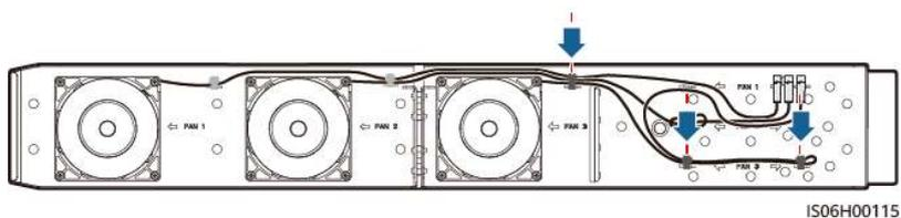
**Étape 8** Poussez le plateau du ventilateur jusqu'à ce que la plaque de déflecteur du ventilateur affleure le boîtier de l'onduleur.
