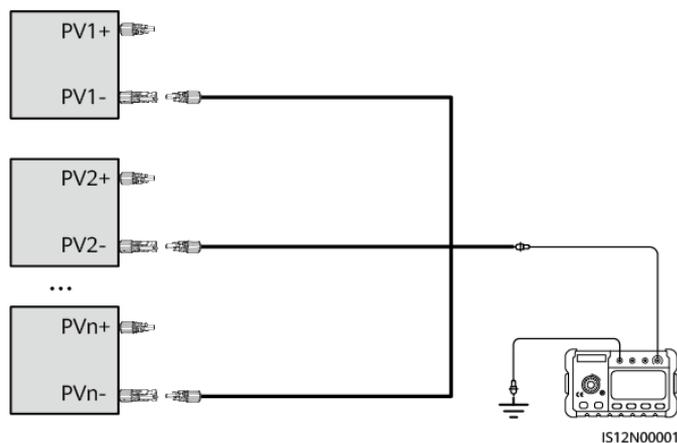
**Étape 7** Insérez les connecteurs positif et négatif dans les bornes d'entrée CC positive et négative correspondantes de l'onduleur.
