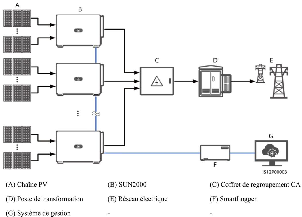
**Figure 5-2** Mise en réseau RS485 (Smart Dongle)
