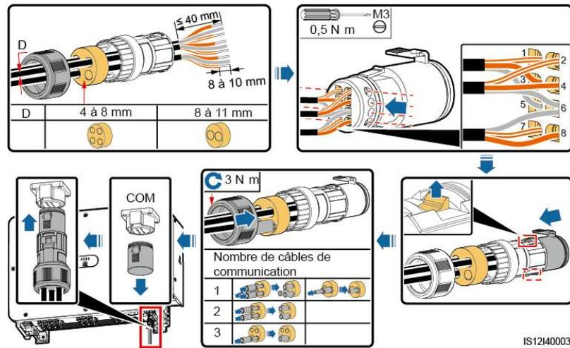
**Figure 5-33** Raccordement des câbles de communication RS485 (anneau en caoutchouc de 4 à 8 mm à deux ou trois trous)
