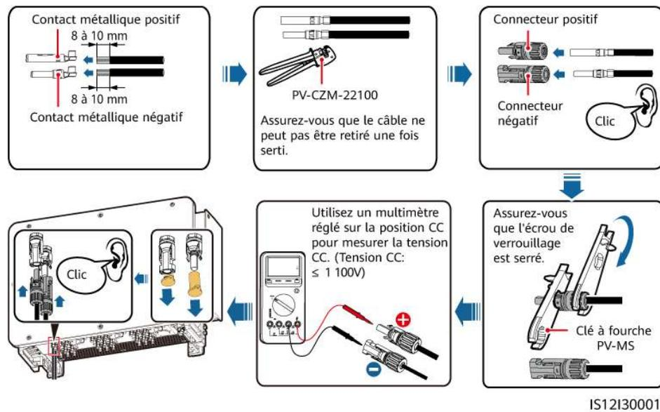
Figure 5-29 Connexion des connecteurs
